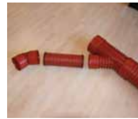
5. Einbau des Rohrstückes zwischen den Formstücken.
