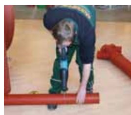
3. Ablängen des Rohrstückes von der 6 m Stanze.
